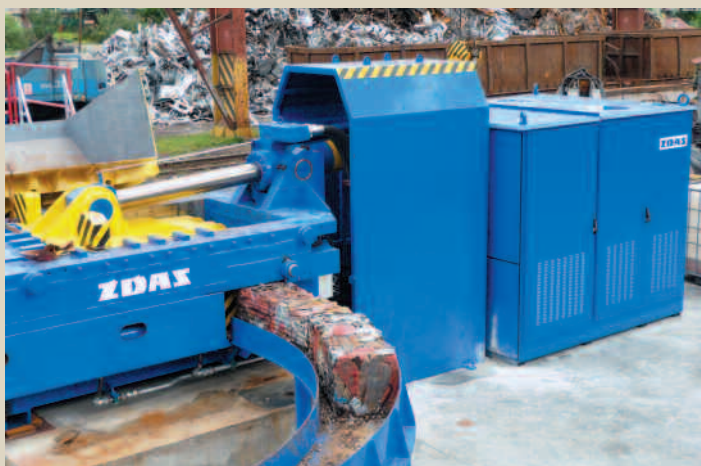
Составной частью пресса является и транспортер готовых пакетов.
