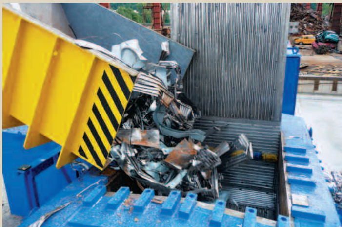
Опрокидная воронка пресса CPB 200 позволяет нетрудную загрузку лома
