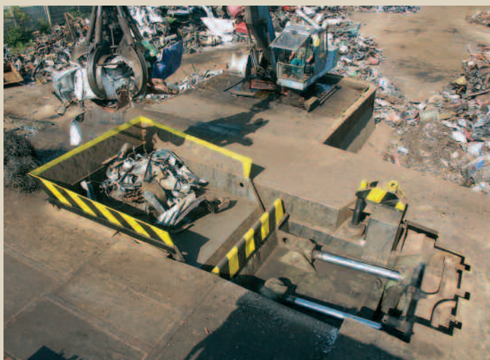
Открытие крышки дает достаточное пространство для загрузки лома
