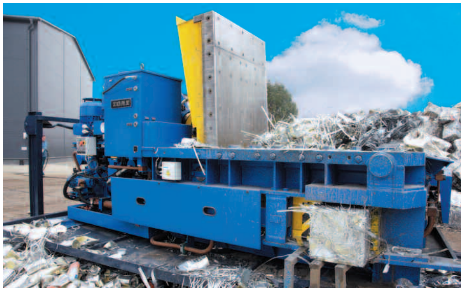
Открытием крышки возникает достаточное пространство для загрузки лома.
