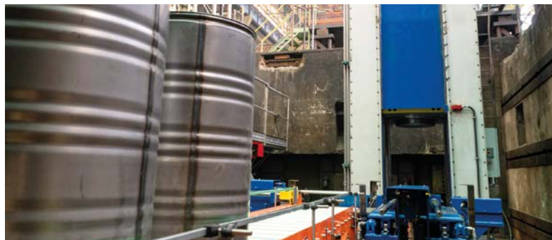
Při přejímce byl na montáži odzkoušen vysokotlaký lis HDP 2000 pro německou firmu NUKEM. Konečným zákazníkem je Chmelnická jaderná elektrárna na Ukrajině, kde bude lis sloužit ke zhuťování radioaktivního odpadu.
