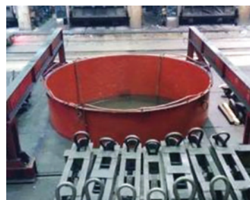
Stávající vodní kalící nádrž před rekonstrukcí
